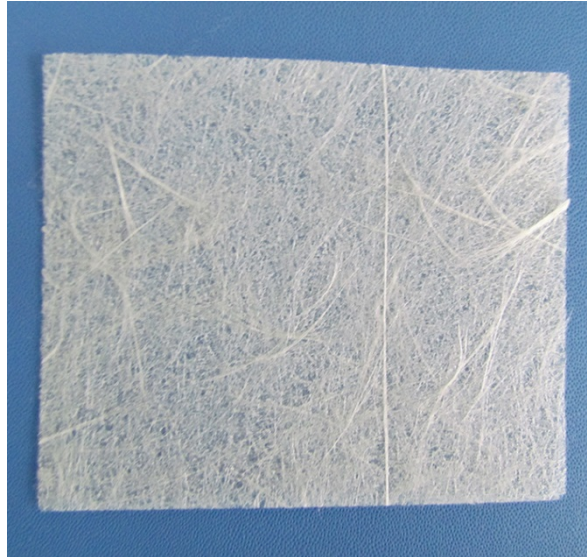
Слика 5.2. Слој стакленог мата - ојачање
