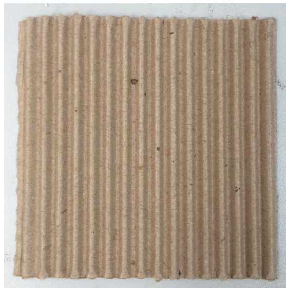
Слика 5.8. Слој ребрастог картона у ЕП-СВ-К композиту
