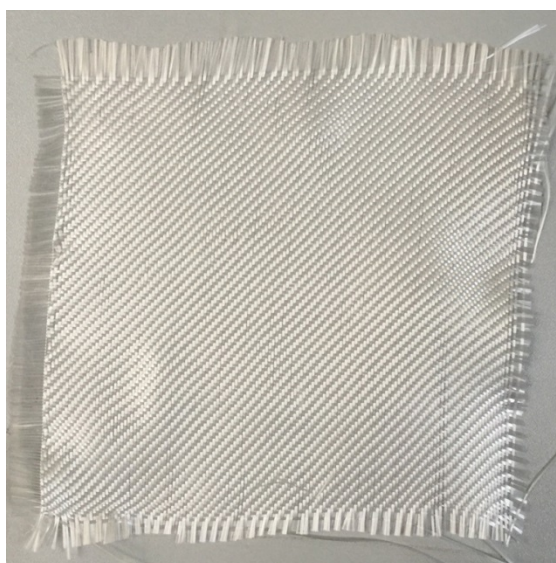
Слика 5.9. Слој стаклених влакана у ЕП-СВ-К композиту
