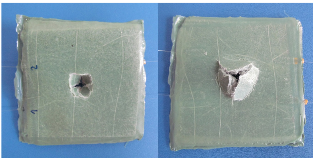
Слика 6.4. Узорак ПЕВГ-СМ-1 након седмог удара брзином од 3 m/s
