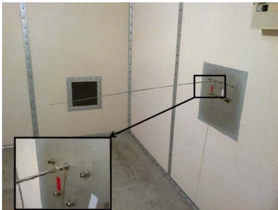
Slika 3.6 Položaj horizontalne monopol-antene u Faradejevom kavezu
